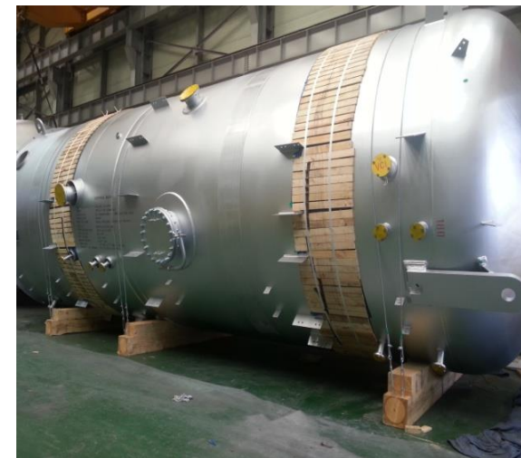
EW Sludge Separator PKG
